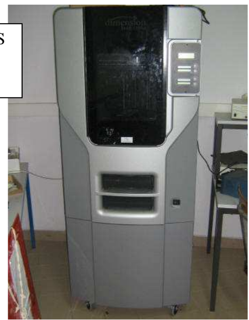
Imprimante 3D pour le prototypage rapide (Réalisation des pièces modélisées en 3D avec Solidworks)
