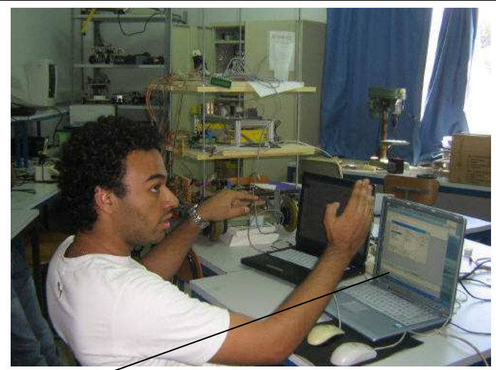
La pince est programmée pour suivre le mouvement de la Wiimote (accéléromètre intégré)
